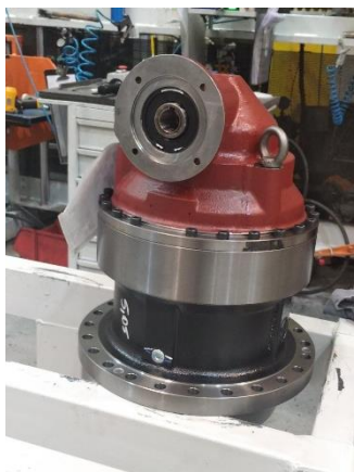
Figura 07 – Montagem final do redutor
